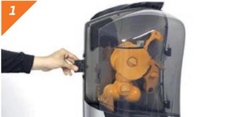
Öffnen Sie die Verriegelung der Schutzhaube.
