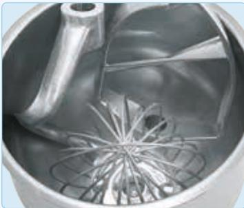
Für effizientes Arbeiten sind Kessel und Werkzeuge perfekt aufeinander abgestimmt. Die Rührmaschine startet den Rührvorgang nur, wenn der Kessel in der richtigen Position ist
