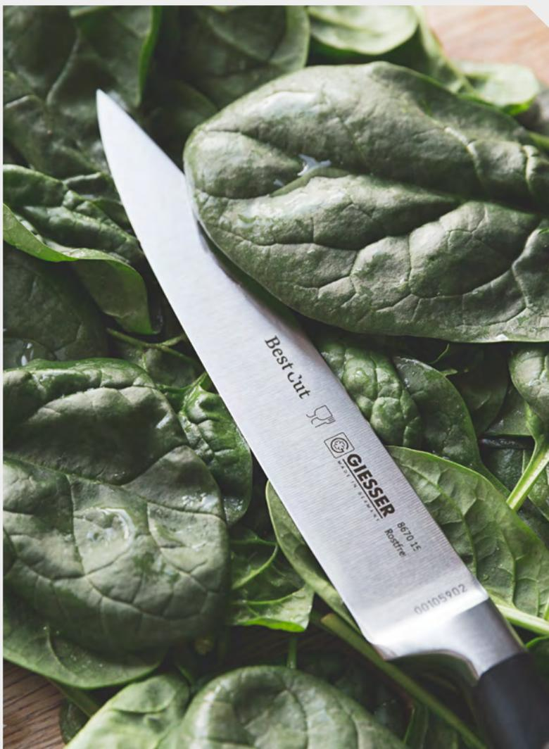
Aus einem Stück Stahl geschmiedet, angereichert mit besonders viel Kohlenstoff (X55) und gehärtet im Vakuum auf 56 - 57 HRC: Die Messer der BestCut-Serie gleiten sicher und ohne Abrutschen durch jedes Schneidgut. Durch den besonderen Schliff sind auch harte Schalen oder Krusten kein Problem. Bei der Oberfläche der ergonomisch gestalteten Griffe haben wir
