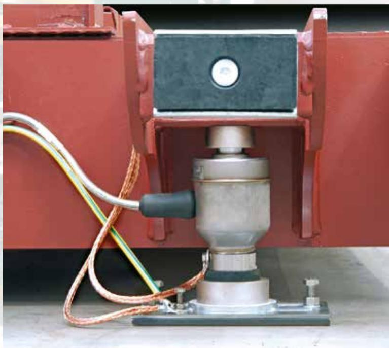
Nelle celle digitali i dati di calibrazione di ogni cella vengono **memorizzati nella memoria elettronica, facilitando** così la calibrazione, ricerca guasti, manutenzione e riparazione.
