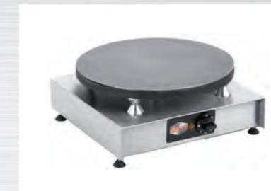
Crêpe-Geräte sind runde, zumeist aus Gusseisen hergestellte beheizte Platten, auf denen der Crêpe-Teig in einer hauchdünnen Schicht aufgetragen wird. Crêpe-Eisen können entweder mit Gas oder mit Strom betrieben werden. Die bei Groß und Klein beliebten Waffeln sind auf den Speisekarten zahlreicher Gastronomiebetriebe zu finden. Das Backen der Waffeln übernehmen Waffeleisen.
