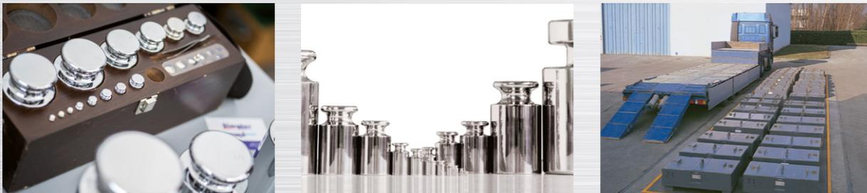
Gewichtsstücke werden seit alters her zum Durchführen von Wiegungen eingesetzt. Heute werden Gewichtsstücke fast ausschließlich zum Justieren und Prüfen = Kalibrieren von elektronischen Waagen eingesetzt.
